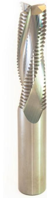
Сpirальные черновые фрезы Z3 RH с выбросом стружки вверх позволяют снимать большое количество материала с сохранением высокой скорости подачи по сравнению с чистовой. Благодаря положительному направлению спирали, подходят для зафиксированных заготовок на рабочем столе лицевой (обработанной) поверхностью вниз. Трёхзаходность фрезы позволяет подавать материал со скоростью 9-15 метров в минуту (в зависимости от количества оборотов, оснастки и материала).
